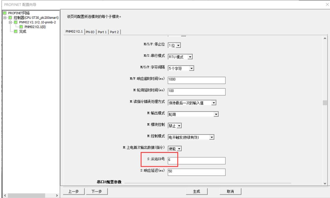
6、选中 PNM02-pnmb-2,将右侧的从站模式下读写命令添加到插槽内。点击生成，完成对网关 PNM02 从站模式的配置。
