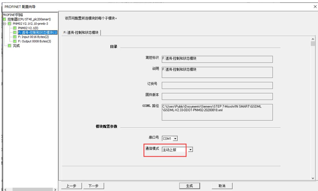
将网关设置为**主动上报**模式，网关串口 1 接调试串口工具模拟现场设备（比如扫码枪、称重仪表等）。可在控制和状态模块、输入输出数据模块监控到相应的值的变化。
