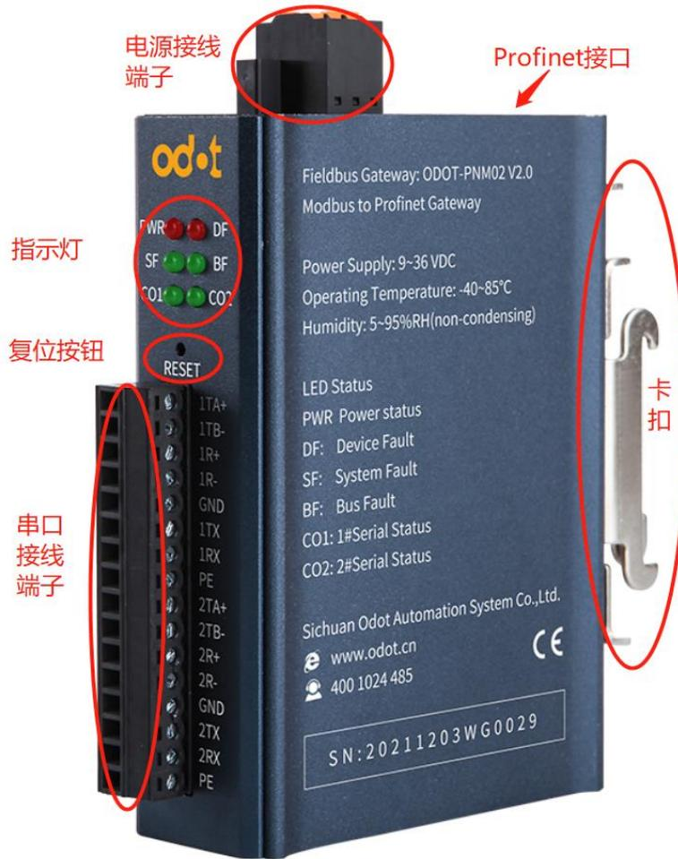
上面板有两个 ProfiNet 接口和电源接线端子。PORT1 与 PORT2，两个接口功能相同，此两接口具有交换机功能，即上位机电脑可以通过 PORT1 接口访问连接于 PORT2 上的设备，如下图（电脑 IP 为 192.168.1.92，电脑接 PORT2 口，西门子 S7-1200 接 PORT1 口），上位机软件可搜索到同一个 ProfiNet 网络中的设备。
